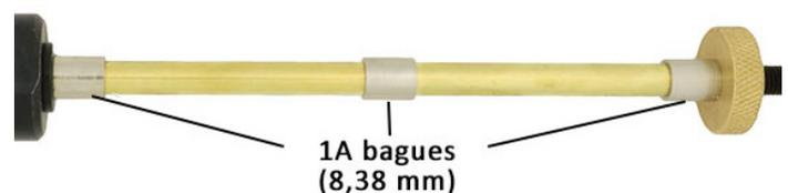
1. Placez les bagues et les barillets sur le mandrin en suivant le schéma ci-dessus.
